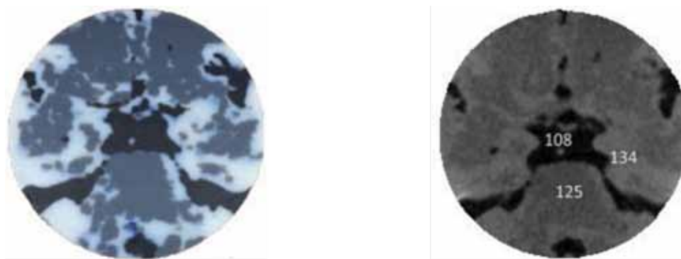
Рис. 4. Фантом, изготовленный на 3D-принтере, с единицами радиационной плотности по Хаунсфилду (HU) Fig. 4. Phantom manufactured on a 3D printer with units of radiation density according to Hounsfield (HU)
